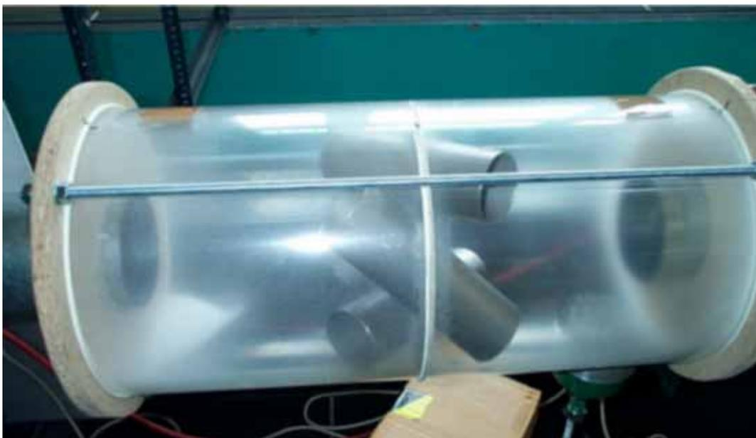
Abbildung 4.1.3: Strömungsgeschwindigkeit 40 m/s, Prüfzeit 2 min
