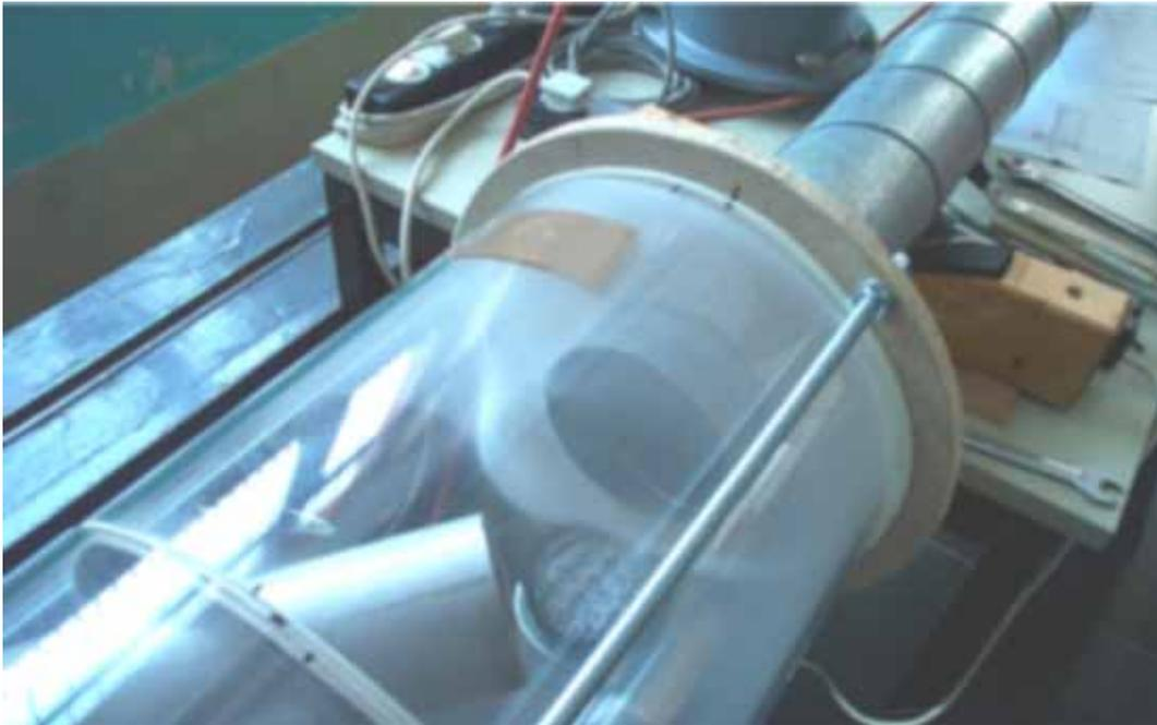
Abbildung 4.3.9: Strömungsgeschwindigkeit 35 m/s, Mitnahme der Prüfpartikel
