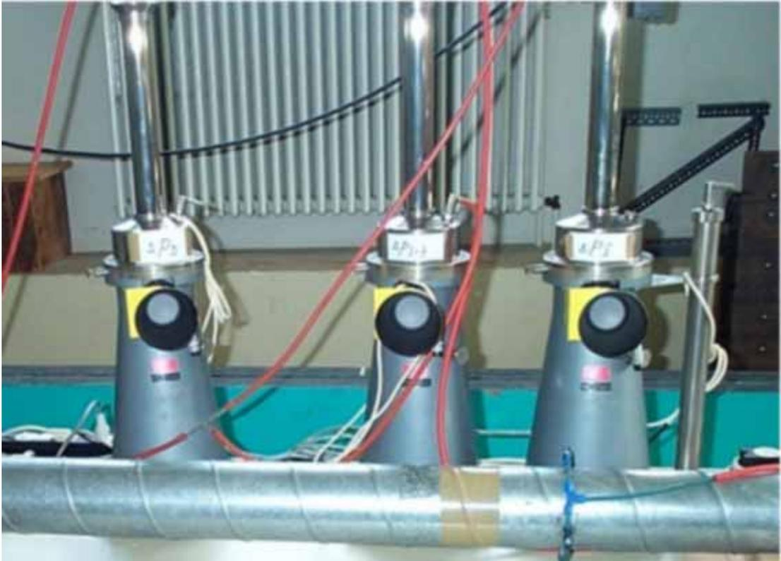
Abbildung 3.3.1: Betz-Präzisionsmanometer zur Druckverlustmessung
