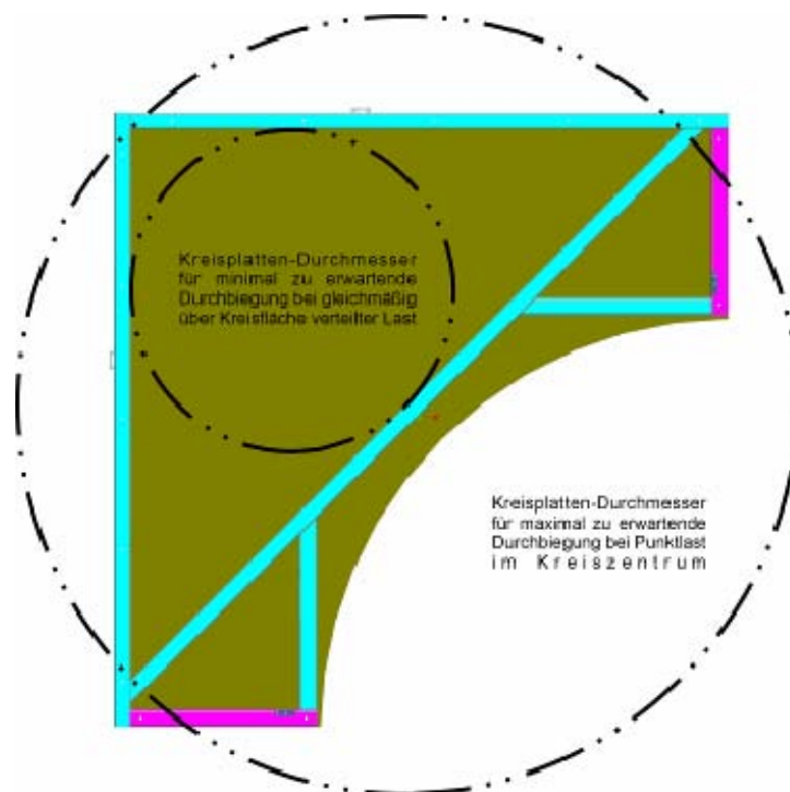
Abb. 13: Durchmesser der berechneten Kreisplatten
