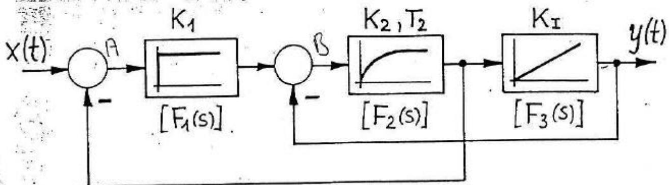
a) Ermitteln Sie die Übertragungsfunktion  $F(s) = Y(s)/X(s)$  des Systems in Abhängigkeit der Übertragungsfunktionen der drei Teilsysteme, also  $F(s) = f(F_1, F_2, F_3)$ .
